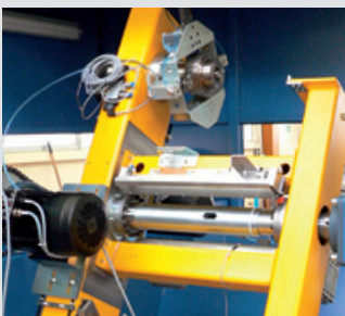
Der Dreharm – das Herzstück der Aufwickleinheit.
