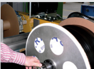
Die Aufwickleinheit wickelt den Schlauch auf eine Rolle, schneidet ihn ab und stellt die Schlauchrolle zur Entnahme bereit.
